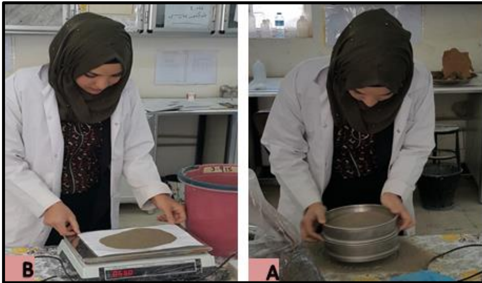
المصدر : التقطت الصورة في المختبر أثناء عملية فصل الأحجام ووزنها بتاريخ 2020/3/3.
