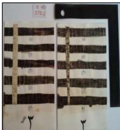
صورة رقم (10) حبر تانات الحديد المكشوط والممسوح بعد الترميم والإنعاش بمحاليل العفص، الإهليلج، حامض التانيك، حامض العفصيك والبيروجالول مقارنة بغير المعالجة
