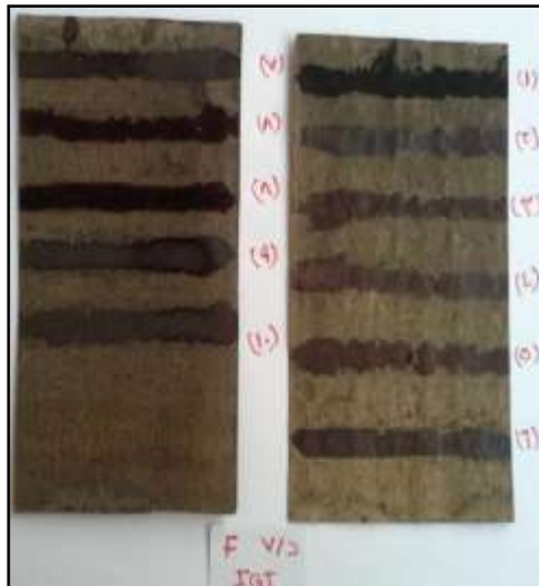
صورة رقم (1) حبر العفص الحديدي الباهت قبل وبعد إنعاشه بمحاليل الدراسة العشرة في شكل خطوط
