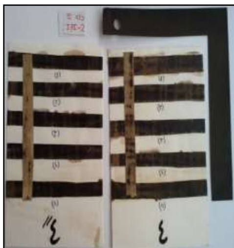
صورة رقم (11) حبر بيروجالول الحديد المكشوط والممسوح بعد الترميم والإنتعاش بمحاليل العلاج الخمسة مقارنة بأشروته غير المعالجة
